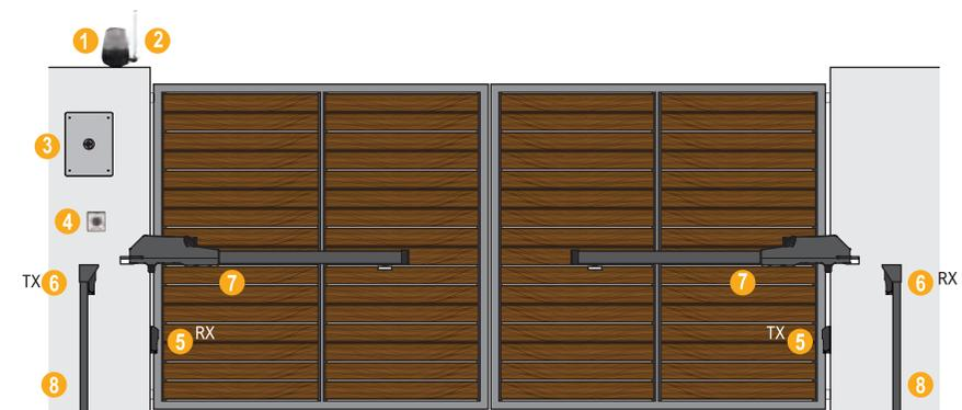
1\_Blinker 2\_Außenantenne 3\_Steuerung 4\_Schlüsselschalter 5\_Lichtschranken/ schließen
