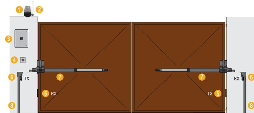
1\_Blinker 2\_Außenantenne 3\_Steuerung 4\_Schlüsselschalter 5\_Lichtschranken/ schließen
